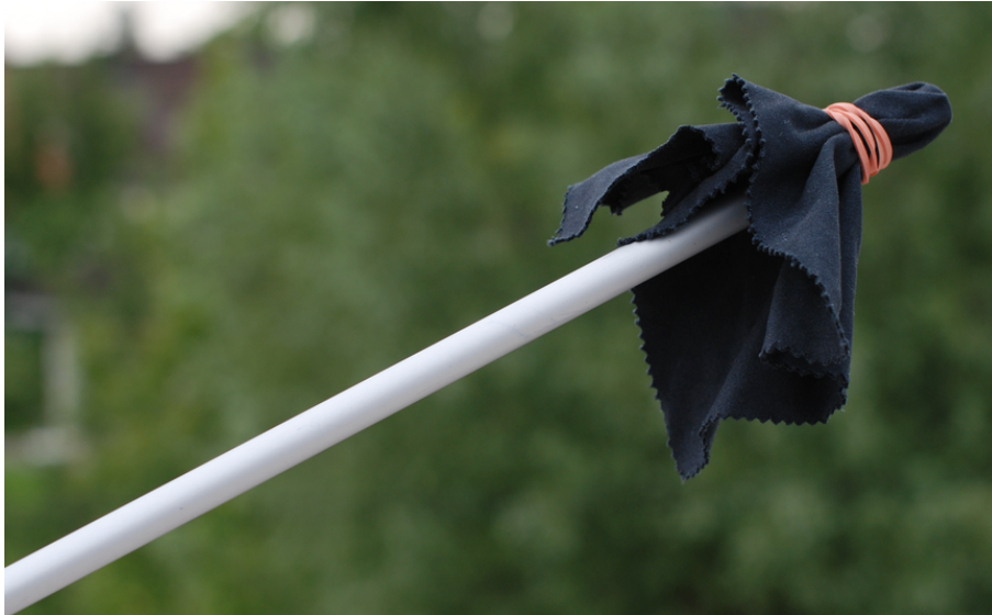
Abb. 9: Ein auf den Abstand der beiden Spiegel zugeschnittener Aluminiumstab wird an den Enden mit einem Mikrofasertuch umwickelt, um beim Einrichten des Abstandes der beiden Spiegel deren Beschichtung nicht zu beschädigen.
