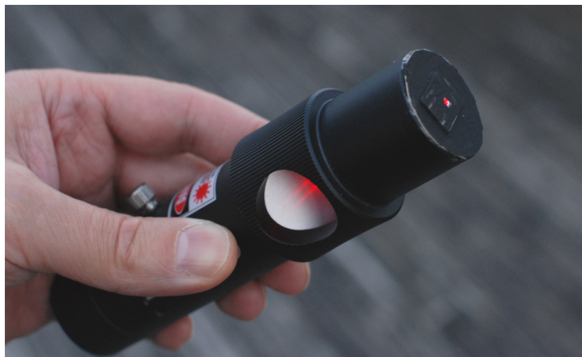
Abb. 8: Justierlaser. Am fernrohrseitigen Ende wurde ein Blech mit einer 1mm Bohrung angebracht, um nur den zentralen, genau mittig austretenden Teil des bei diesem Modell zu breiten Laserstrahles zu nutzen.
