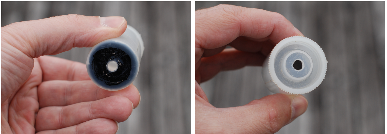
Abb. 6: Diese alte Filmdose dient mir seit vielen Jahren als wichtigstes Hilfsmittel zur Justierung meiner Schiefspiegler.
