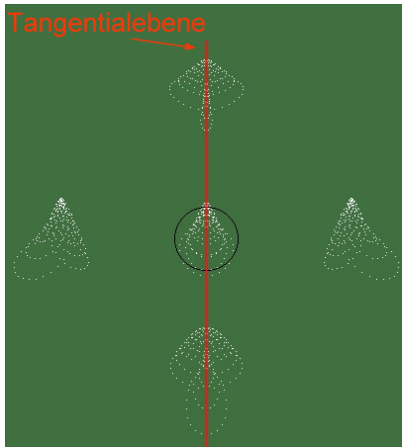
Abb. 2. Die zweiseitige Symmetrie des Schiefspieglers zeigt sich auch im Bildfeld. Die Spotdiagramme liegen spiegelbildlich zur Tangentialebene.
